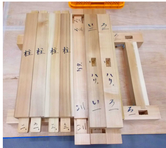
組み立て (柱・桁)
